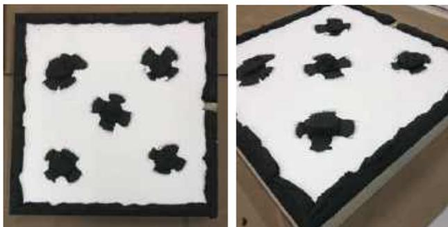
**Примечание.** При монтаже противопожарных расщечек клеевая/армировочно-клеевая смесь наносится сплошным слоем без образования воздушных полостей и пустот.
