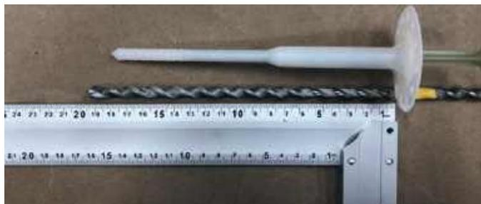
Для контроля глубины бурения или сверления отверстия под тарельчатый анкер применяют ограничитель. В качестве ограничителя может использоваться специальная насадка на перфоратор или сигнальная (контрастная) лента, накрученная на бур.
